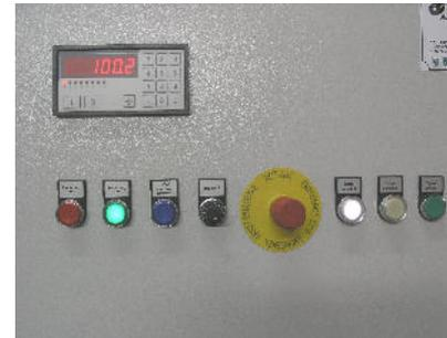
Einfache Posi-Steuerung CPS20 mit SPS und Schwenkpanell oder Ständer
