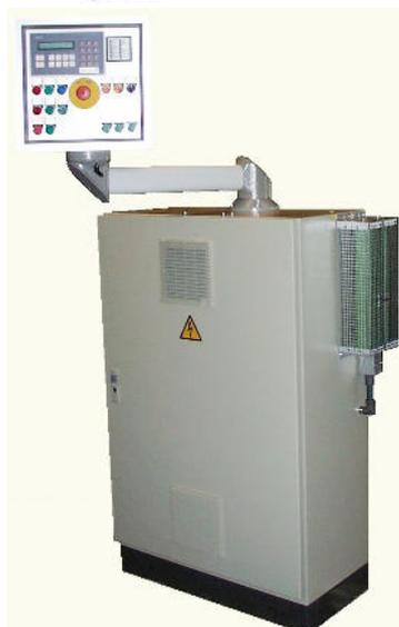
Schaltschrank mit aufgesetztem Schwenkarm- Panel
