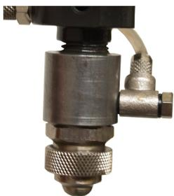
Die Befestigung der Sprühdüse mit dem Düsenaufsatz für Öle mit hoher Viskosität erfolgt auf gleiche Weise wie oben beschrieben!
