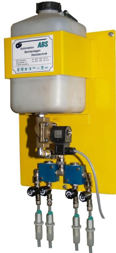
**Dosier-System für Rollenbandöler mit Tank 10 l**
